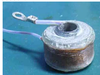
図1 直径3 cmの小型コイル
