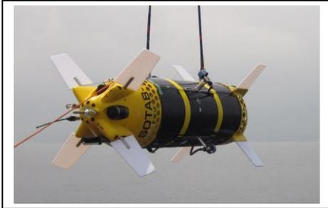
海底からの重油やガスのブルームの自動追跡を行う海中ロボット (SOTAB-I) は、2013年 3 月に製作された。最大潜航深度は、1、500m である。
