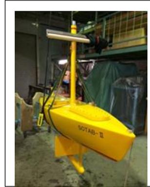
器を載せるための排水量の観点から、セーリングヨットの船型を用い、油検知センサーを含む各種機器の搭載を考慮して、キールの高さと取り付け位置、帆で浮流重油を追従させるのに必要なプレーキ板、舵、ジブセールの大きさを、動的復原性と操縦性の観点からシミュレーションを行うことにより設計した。また色々な条件に対応できる浮流重油を自動追跡する制御系の設計を行った。
