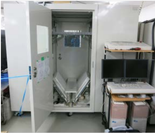
図1：2方向エックス線透過装置（慶應義塾大学・医学部に設置）
