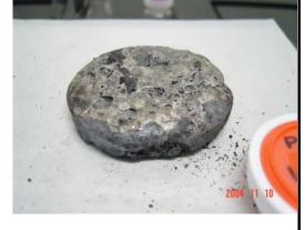
銑鉄が生成していたが凝集し解け落ちるまでには至らなかった。これは炉の設定の都合で3時間という長時間炉内を通したためである。現在、短時間加熱での実験を準備している。新マイクロ波炉を考案し、現在、特許出願の準備をしている。
