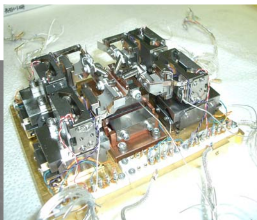
図 3. 4 探針 STM ヘッド機構
