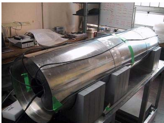
図1：4層のパーマロイ磁気シールド
