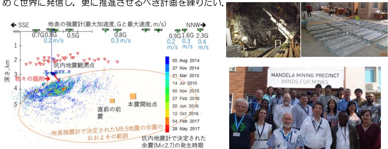
図：M5.5 地震の余震発生帯上縁部を地下 2.9 km から掘削調査。写真左上：掘削マシン，写真右上：掘削回収した総延長 1.6 km の円柱試料の一部，写真下：研究チーム(前列中央が代表者)。
