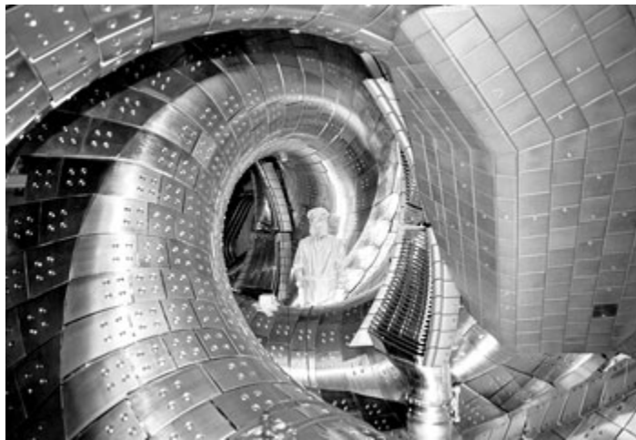
図1 核融合研究所LHD装置の内部写真 真空容器を中性粒子の直射から守るアーマータイルと、後ろにICRFアンテナが見える。ICRF加熱の共同研究は日中共同研究の主要課題の一つである。
