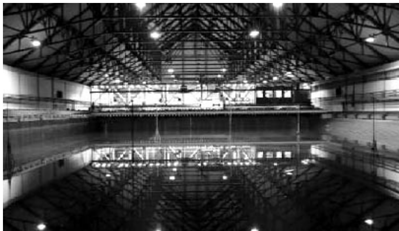
図3 最新の設備を誇るインドネシア応用科学技術評価庁の海洋水槽
