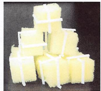
写真1. 研究で用いたポリウレタン製スポンジ担体。DHSリアクターは吸水後の担体を積み重ねる構造を取るため、担体が自重で潰れないように周囲をプラスチック製の棒で囲った。
