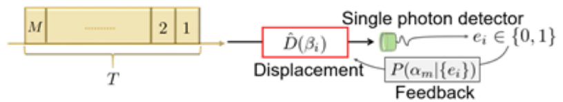
Fig.1 光子検出器を用いたフィードバック測定系の概略図。
