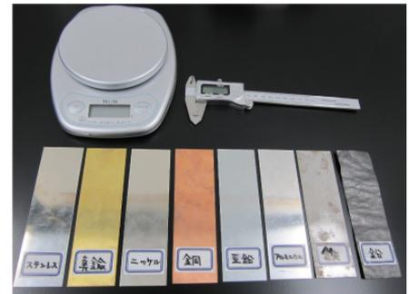
図 2 密度を計算する際に使用した計測器と金属板
