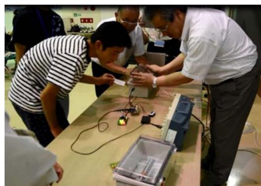
標準線源からのアルファ線を計測。パルスカウンターのLEDが点滅して計数を示す。
