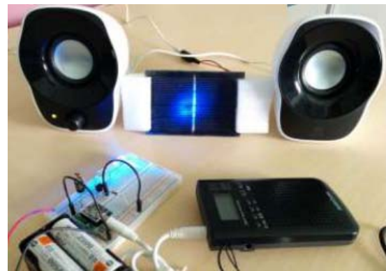
図5 可視光送受信機(上:受信側, 下:送信側)
