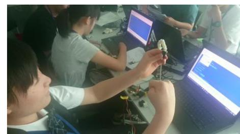
ていることを実感させることである。受講生は、力の入れ具合と個人差のある筋電信号の信号強度を調べながら、それに応じたモータ角度を変化させるプログラムを作成しており、中には、指を曲げる力の入れ方でロボット指を伸ばすような制御プログラムを考案して作成するなど創意工夫しながら調整する生徒も多く存在した。
