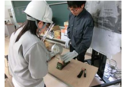
図 2 低融点金属を溶かして金型に鋳込んでいる様子
