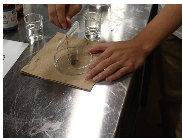
写真 5 水素マイクロプリント法模擬実験
