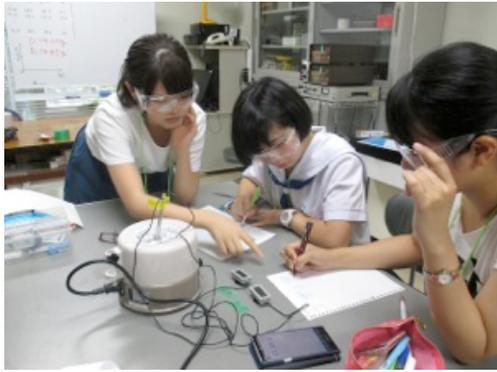
大学生の補助で酢酸ナトリウムの熱分析実験
