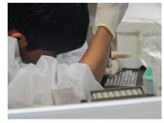
最終講義のあとで、既に反応が終わっている試料を寒天で作成したアガロースゲルに添加して電気泳動を開始する。水溶液中においては、DNA はマイナスに荷電しているので、人為的に電位差をかけると DNA はアガロースの網の目の中(抵抗)をその分子量にしたがって陽極側に移動する。アガロース電気泳動で分離した PCR 産物を観察した。エチジウムブロマイドは、DNA を含む核酸のくぼみに入り込む性質を持っており、短波長の紫外線を照射するとオレンジ色の蛍光を出す。したがって、その蛍光を発する場所に目的とする PCR 産物が存在することになるわけだ。わずかな PCR 産物の移動度の差によって、アルデヒド脱水素酵素遺伝子の型を知ることができる。しかしなが
