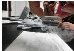
超伝導体の磁気浮上実験 (フィッシング効果)
