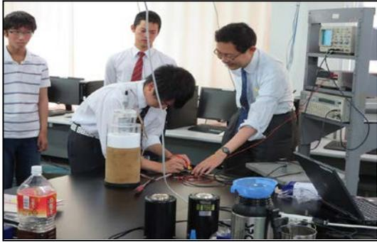
ロックインアンプを用いた、酸化物高温超伝導物質の電気抵抗測定
