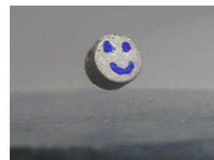
超伝導体の上で 浮遊する磁石
