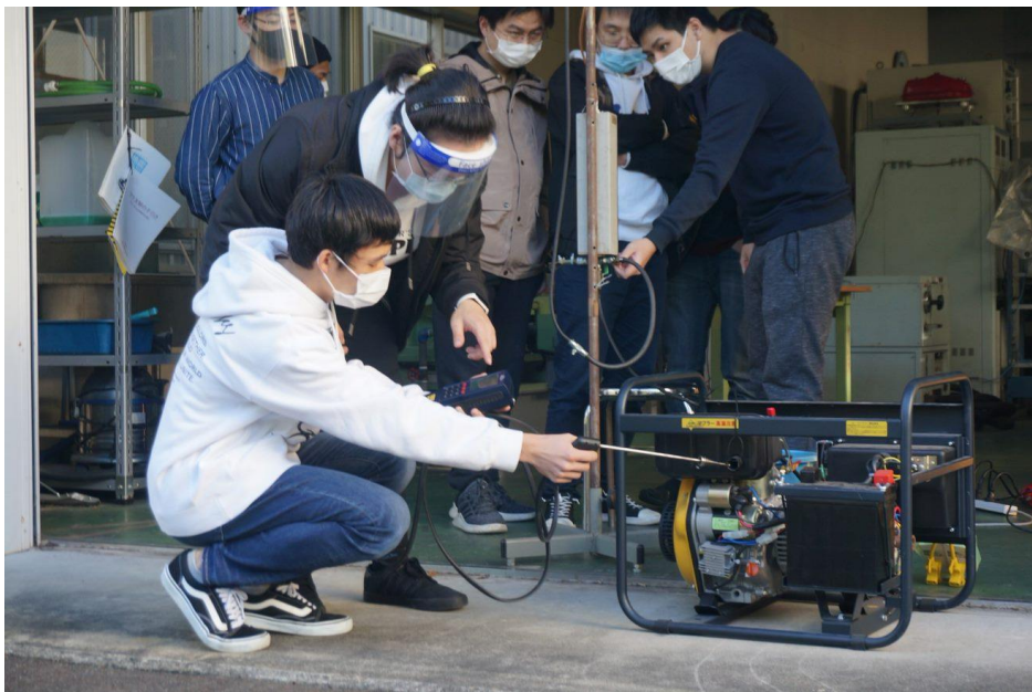
図7 BDF 燃焼ガスの測定
