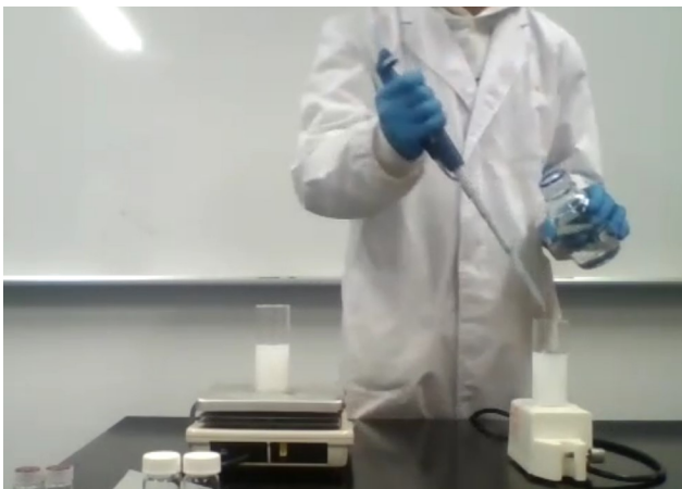
図2 リン酸カルシウムスラリー中に、分散剤を添加し徐々にスラリーの透光性が上がっていく様子
