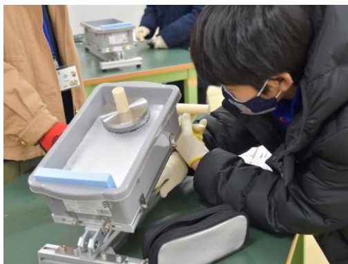
計測器を用いた摩擦角の計測の様子
