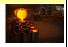
は、約250°Cで溶けるピューターと約660°Cで溶けるアルミニウム合金を使った鋳造による小物づくりを体験してもらいます。融点の異なる2種類の金属の鋳造によるものづくりを通じて、肌をなでる熱風の温度感の違いや、取り扱いの難しさの違いなどを実感してもらい、鋳造という工学的に大変重要な加工プロセスについて興味をもってもらい、材料学・理工学の楽しさを味わってもらえればうれしいです。
