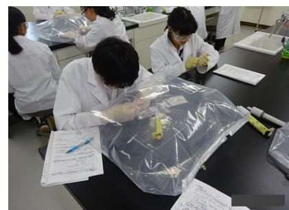
図2 グローブバック内での電池の組み立て作業の様子(実験②)。
