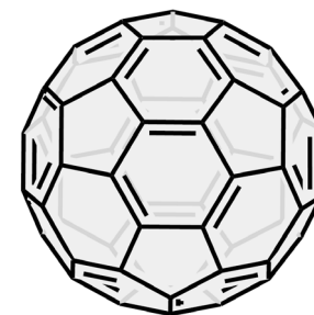
図1 フラーレン C_{60} の構造
