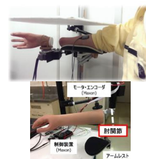
図2 筋電信号で制御されるロボットアーム
