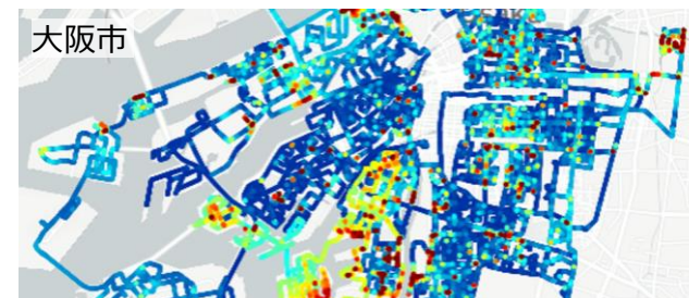
図3 車載システムによるメタン濃度 (暖色ほど高濃度)
