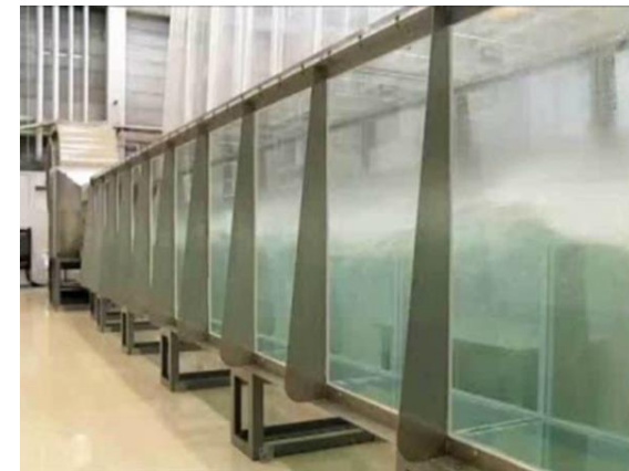
図1 京都大学・台風シミュレーション水槽の写真 (Komori et al., 2018を基に作成)
