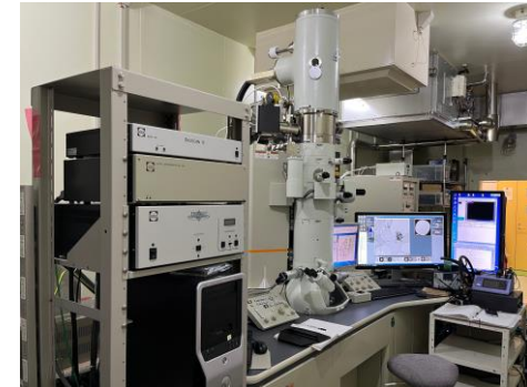
図1 液中観察を主目的として構築してきた透過型電子顕微鏡。
