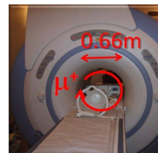
図1 医療用MRIサイズの蓄積リングに \mu 粒子を蓄積するイメージ
