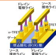
図3 III-Vナノワイヤ/Siトンネル接合縦型TFET立体集積構造図
