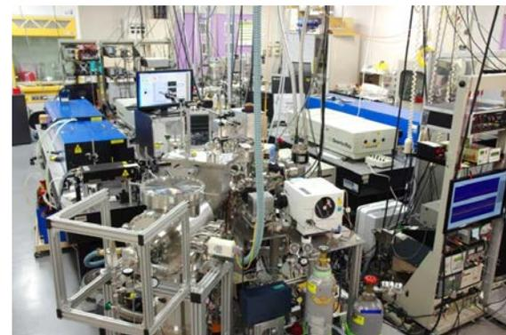
図2 極低温氷表面における分子生成を調べるために開発した超高真空実験装置
