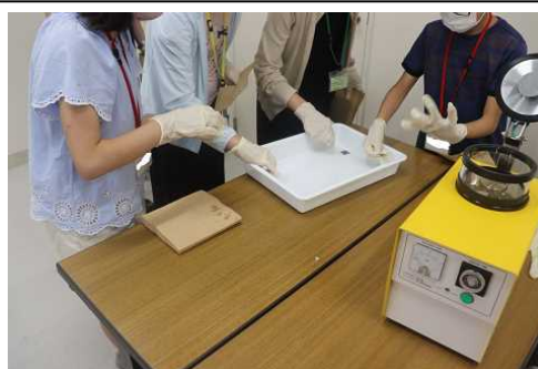
フォトリソグラフィ実験の様子 太陽光で露光したサンプルを現像しています
