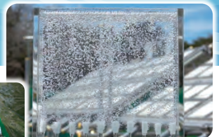
光触媒による水素発生の様子
