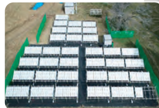
光触媒による水素発生の様子
