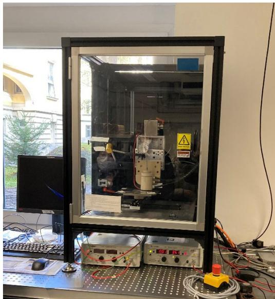
図 3. ウルツブルグ大学の 3D-MEW プリンターの写真(2022年11月26日)。
