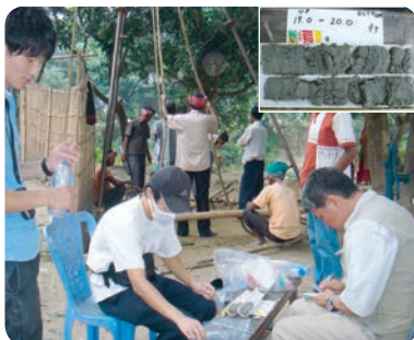
図1 バングラデシュでの掘削調査風景 後方は手作業で行うコア掘削。手前では掘削された試料についての記載をしている。ヒ素汚染地下水の帯水層の堆積物は、化学的風化作用のあまり進んでいない青灰色の砂で、雲母類と緑泥石を多く含んでいる(右上)。
