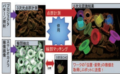
図2 輪郭と点群の双方を用いた3次元モデルとのマッチング
