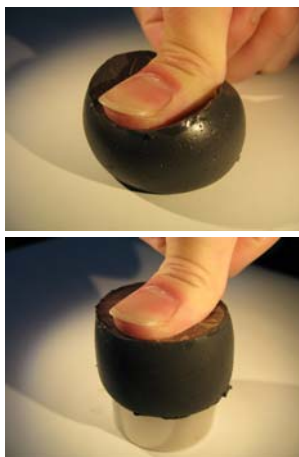
図3: 磁性エラストマーの硬さの変化の様子(上:磁場なし、下:磁場あり(永久磁石))
