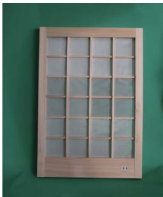
障子太陽電池の試作
