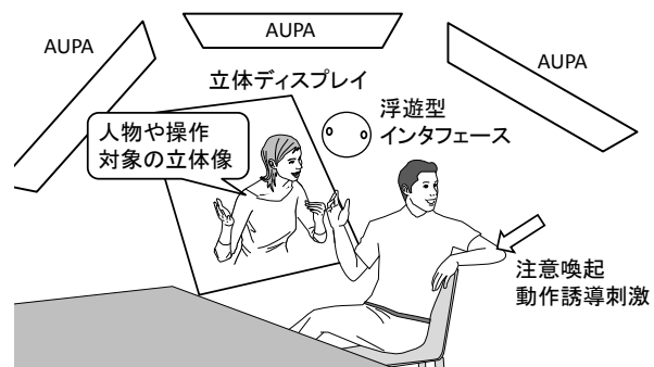
図2 空中触覚テストベンチの基本構成
