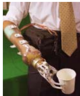
図11 筋電制御義手
