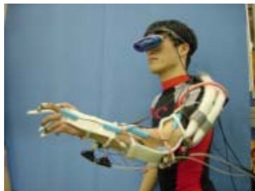
図5 積層型可変粘弾性要素を利用した力提示装置
