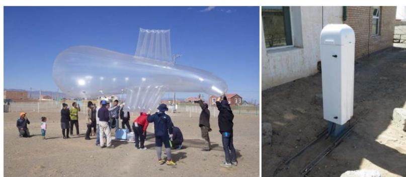
図3 ダスト係留気球（左）とシーロメーター（レーザーレーダー、右）。モンゴルのダランザドガド気象台にて。
