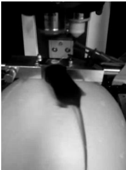
図 3. In vivo 二光子イメージングシステム 視野ブレをなくし、無麻酔マウスのストレスを大幅に軽減できる。
