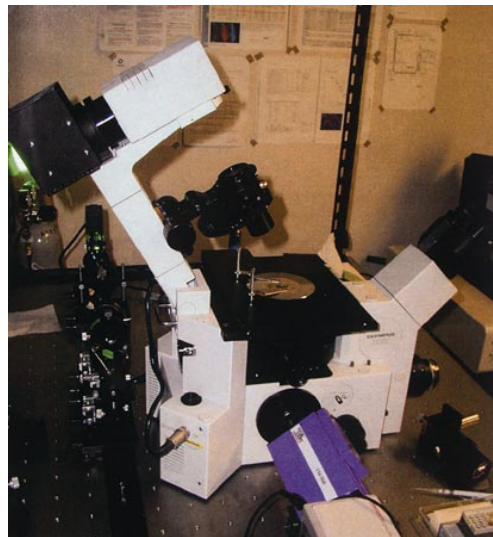
図3 レーザー光を利用する蛍光顕微鏡：研究室で組み立てている段階である。
