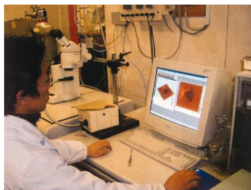
図5 原子間力顕微鏡のモニター画面を見て動作条件を選定する。
