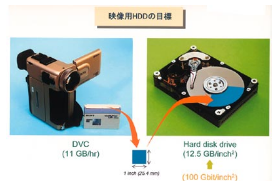
図3 ハードディスク装置による大容量高速映像ストレージの概念図。現行のデジタルビデオテープ1時間分の動画情報11Gバイトが高密度ディスク上の1平方インチに収納できる状態を示しています。
