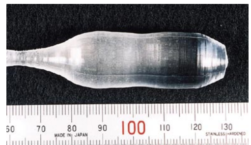
全固体紫外波長可変レーザー応用 新フッ化物単結晶 \text{Ce,Na:LiCaAlF}_6
