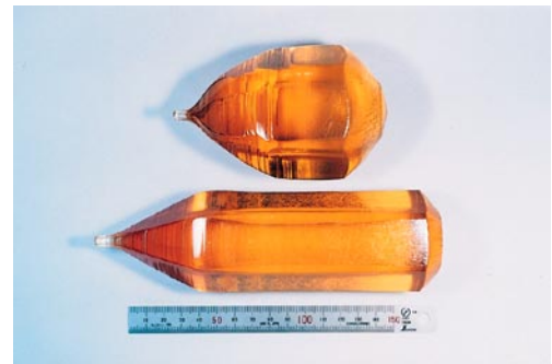
デジタル通信応用新ランガサイト型 大型 La 3 Ta 0.5 Ga 5.5 O 14 単結晶
