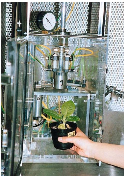
図6 遺伝子銃によるタバコへの遺伝子導入
