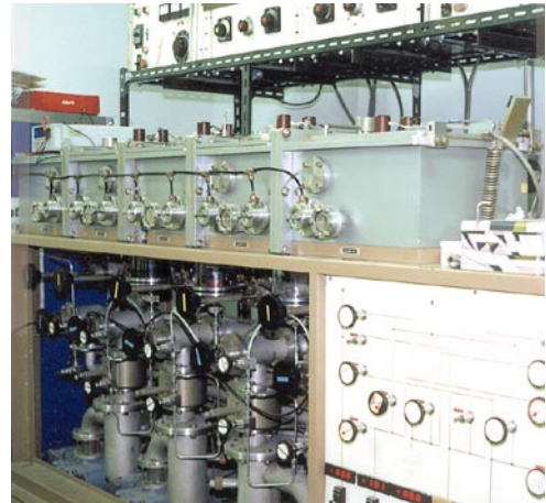
横電場法 3 室分離型プラズマ CVD 装置の外観 プラズマボンバードメントがなく高品位製膜が可能
